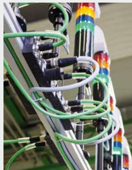
segnalazione, sono utilizzati anche per il collegamento di sensori e attuatori, fino a 16 ingressi o uscite multifunzione parametrizzabili. I moduli Cube67 Cable sono disponibili con cavi di connessione di diverse lunghezze e in differenti configurazioni, compresi quelli a terminale libero.
